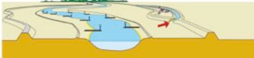
II. Rivier by-pass constructie ten behoeve van periodiek optredend hoogwatersniveau.
