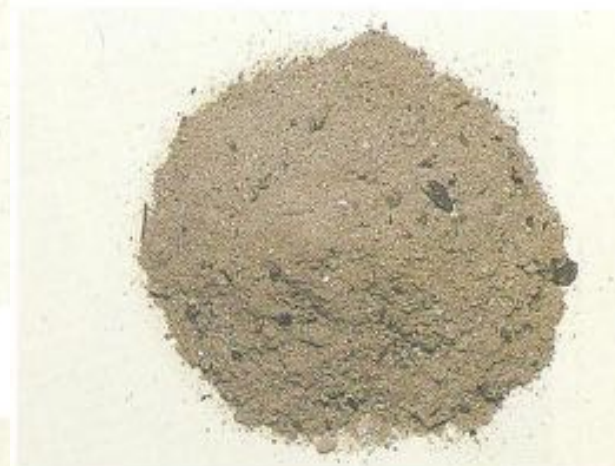
Vliegashuis van kolengestookte elektriciteitscentrale
